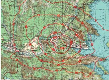
Fig. 1. Isolines of the calculated density of the fluorine deposition in the region of BrAP, kg / (km<sup>2</sup> month) (Изолинии рассчитанной плотности осаждения F в районе БрАЗа, кг/(км<sup>2</sup>·месяц)).
